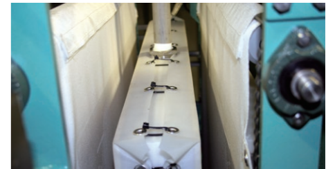
2 隔膜ろ布、移動ろ布とも構造はきわめてシンプルで、交換も簡単に行える構造になっています。
