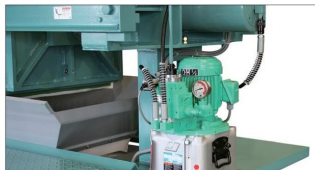
押板とろ板の締付けは、電動油圧ポンプと複動式の油圧シリンダーで自動的に行います。ケーキを排出する際の押板開板は自動で行います。
